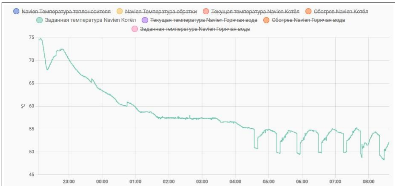
Уставка температуры теплоносителя
