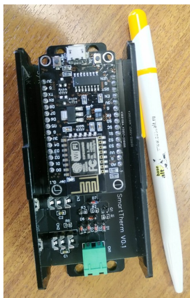
Рис. 3: Контроллер SmartTherm (с процессором ESP8266) с платой V0.1 без крышек. Первый рабочий релиз (снят с производства)
