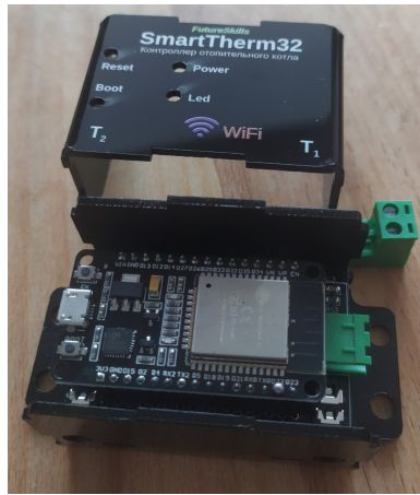
Рис. 6: Контроллер SmartTherm32 со снятой крышкой корпуса. Версия платы адаптера OpenTherm 0.3, корпус с фотопечатью
